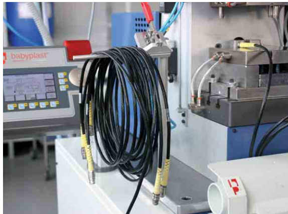
Cable overmold technology Umspritzen für Kabelzug- entlastungen
