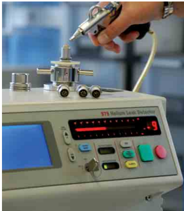
Vacuumtest with leakdetector Vakuumtest mit Leakdetektor
