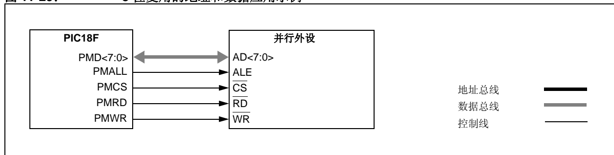
图 11-29: 8 位复用的地址和数据应用示例
