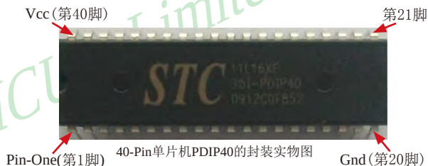
40-Pin单片机PDIP40的封装实物图
