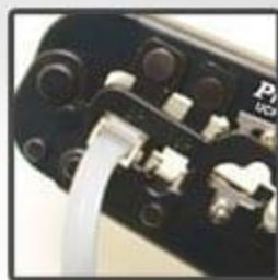
1. 4/6/8P压接 (例如：计算机网线)
