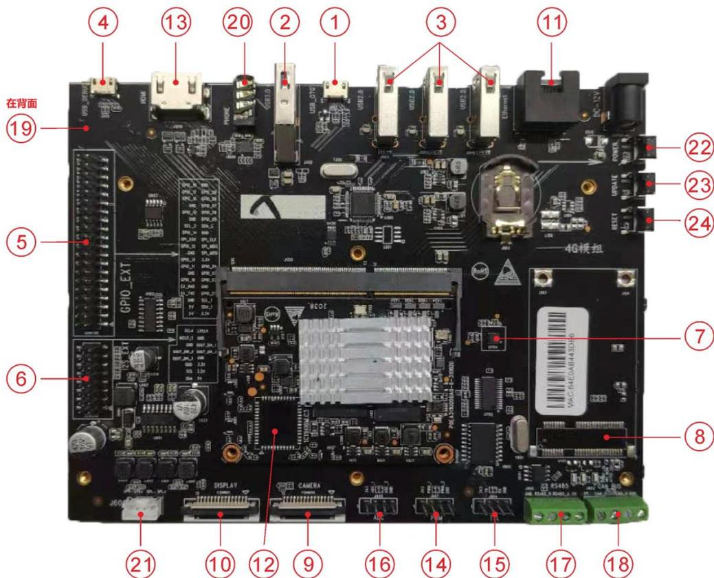
图 3-1 Unionpi Tiger 外形及端口图示
