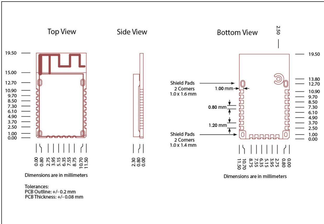
**FIGURE 4-2: RN4020 RECOMMENDED PCB FOOTPRINT**
